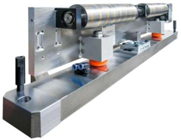
Diese Bauart eignet sich vor allem für den Transport von Stahlplatinen für Strukturbauteile sowie von Abfällen und bietet zahlreiche Möglichkeiten der Modularisierung einzelner oder mehrerer nebeneinander liegender Fördereinheiten. Diese können über eine Keilgelenkwelle miteinander synchronisiert werden, was eine flexible Positionierung der Magnetrollen in der Höhe erlaubt. Es besteht die Möglichkeit zwischen einem externen Druckluft- oder Servoantrieb zu wählen
