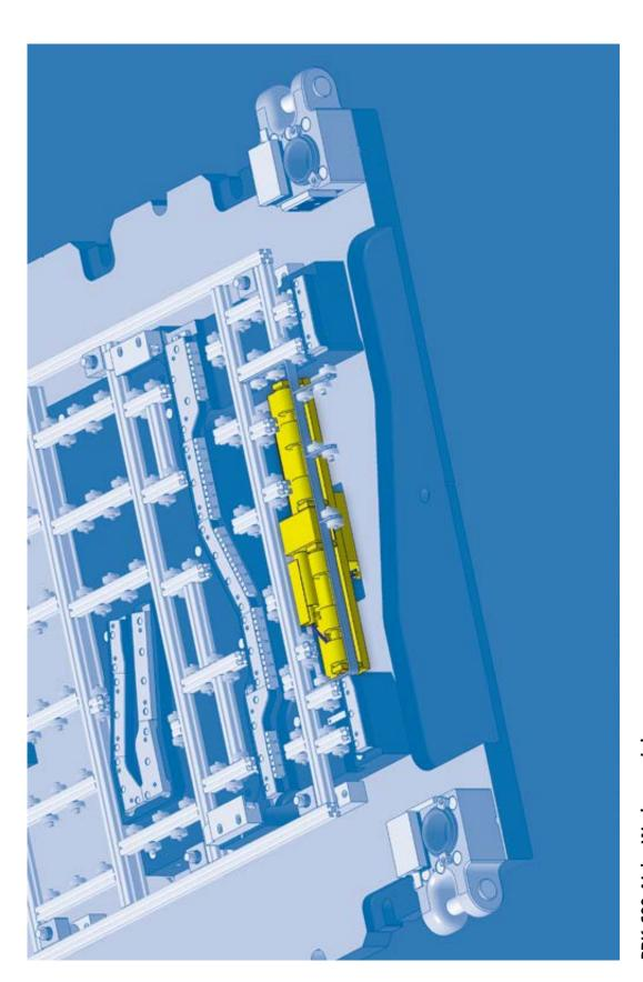
PRK-600-AL im Werkzeugeinbau PRK-600-AL in tooling position
