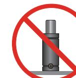
4. Der Arbeitshub muss senkrecht zur Grundplatte der Gasdruckfeder erfolgen, wobei die maximale Toleranz 0,15° beträgt.
