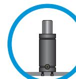
3. Alle Gasdruckfedern müssen mit Schrauben an der Grundplatte befestigt werden.
